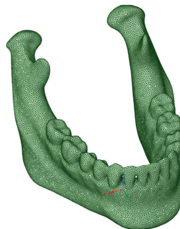
Рис. 3. Сетка метода конечных элементов
