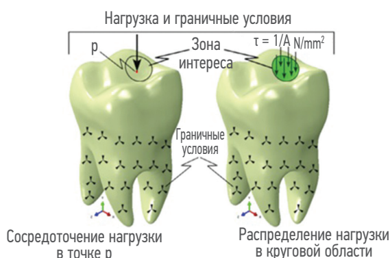
Рис. 5. Схема приложенной нагрузки и граничных условий, наложенных на зуб для точечной нагрузки и распределенной нагрузки
