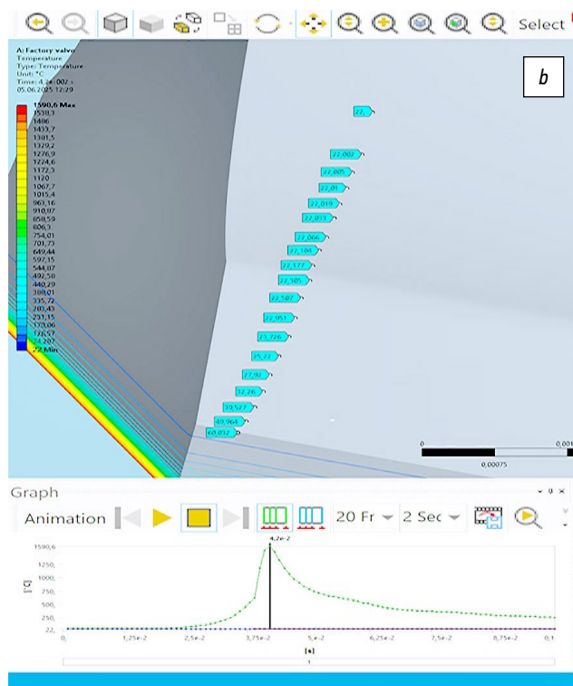
Рис. 10. Фрагмент распределения температуры внутри тарелки клапана от 1590,6^{\circ}\text{C} до 60^{\circ}\text{C} , данное расстояние от max до min температуры = 1 мм (a); распределение T от 60^{\circ}\text{C} до 22^{\circ}\text{C} , на расстоянии более 3 мм вглубь тарелки (b).
