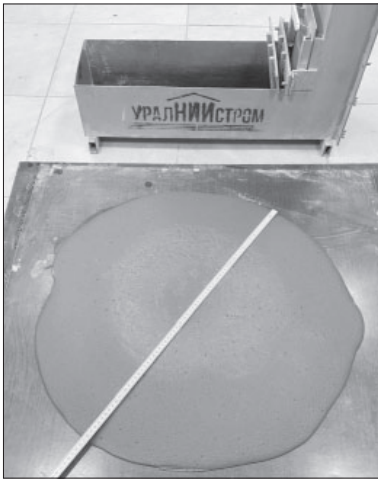
Рис. 3. Смесь для жаростойкого бетона на основе вспученного вермикулита фракции менее 5 мм
